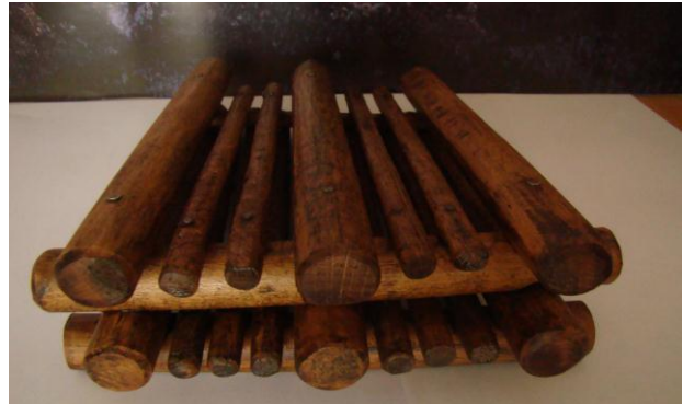
Рис. 4. Макет дерев'яного перепаду, проєктованого до встановлення на р. Стебник на території НППВ
